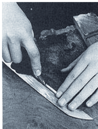
Поверхность вырезанной канавки полируется стальной иглой.
