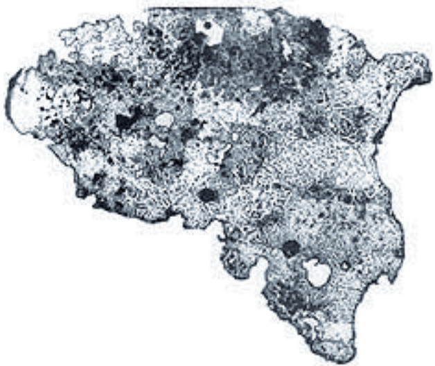
Кусок тамахаганэ после плавки имеет неоднородную структуру со множеством отверстий и частей с различной концентрацией углерода.
